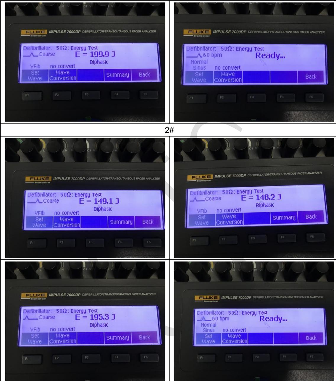
低温工作试验后功能测试照片
